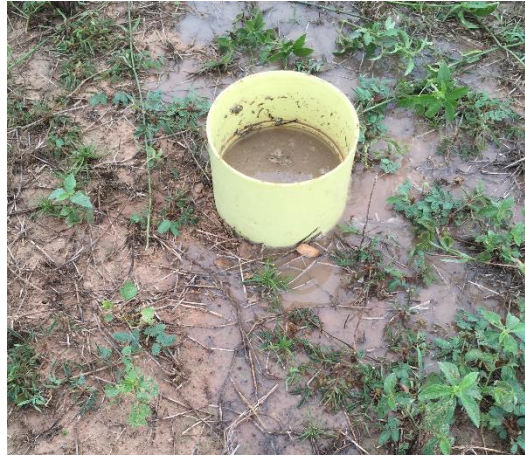
Foto 4.2. Método de medir la infiltración del suelo en campo
