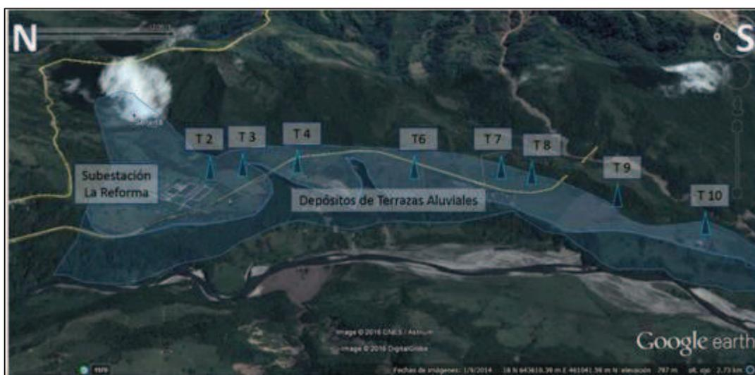
**Fotografía 3.2-12** Mosaico compuesto de registro fotográfico satelital, representativo de localización de Depósitos de Terrazas Aluviales Antiguas (Qt1) en el sector de La Reforma.
